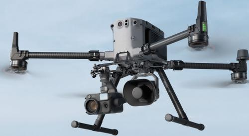
Zenmuse V1 es el primer altavoz de DJI diseñado para plataformas dron con múltiples instrumentos, compatible con Matrice 350 RTK y Matrice 300 RTK. Cuenta con un alto volumen y una larga distancia de transmisión, que admite varios modos de transmisión y lo hace ideal para escenarios como seguridad pública, rescate de emergencia y más.
